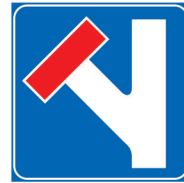
FIG.310 preavviso di strada senza uscita
