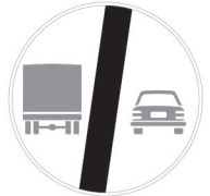
FIG.73 Art. 119 fine del divieto di sorpasso per i veicoli di massa a pieno carico superiori a 3,5 ton.
