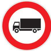
FIG.60/a Art. 117 transito vietato ai veicoli di massa a pieno carico superiore a 3,5 ton.
