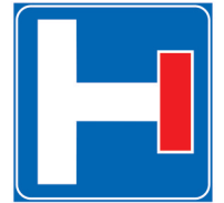
FIG.311 preavviso di strada senza uscita
