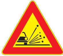
FIG.390 Art. 31 materiale instabile sulla strada
