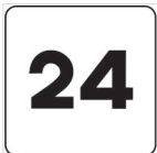
FIG.261 Segnale di progressiva Chilometrica
