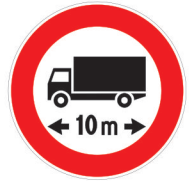
FIG.67 Art. 118 transito vietato ai veicoli o complessi di veicoli aventi lunghezza superiore a ... m
