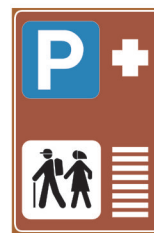
FIG.371 parcheggio di scambio in corrispondenza di itinerari turistici od escursionistici a piedi
