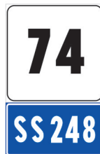
FIG.266 Progressiva distanziometrica per strada statale
