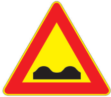
FIG.389 Art. 31 strada deformata
