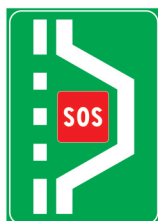
FIG.329 piazzola + sos autostradale
