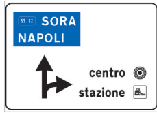
FIG. 233 - segnale di preavviso di intersezione urbana -
