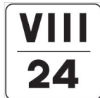
FIG.262 Segnale di progressiva Ettometrica
