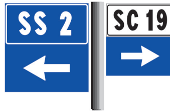
FIG.270 Numeri identificazione strada statale + freccia e strada comunale + freccia con funzione di direzione
